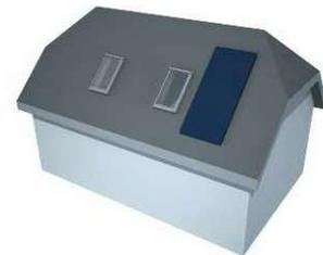
Zwei **symmetrisch angeordnete Flächen** von gleicher Grösse und Ausführung integrieren sich gut, ungleich grosse Flächen und unterschiedliche Materialien dagegen wirken störend.
