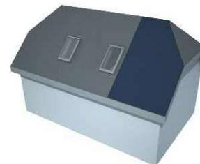
**Parallele Flächen** und Linien von Solaranlagen erzeugen eine starke Integrationswirkung, weil sie die Konturen und den Rhythmus des Gebäudes aufnehmen und wiederholen. Diese Wiederholung ist ein Mittel der visuellen «Unterordnung»: Das Haus dominiert – nicht die Anlage! Falls Parallelität aufgrund spezieller Dachformen – z.B. Walmdach – nicht möglich ist, mildert eine gebührende Distanz zwischen nicht parallelen Linien den visuellen Konflikt zwischen Anlagefeld und Dach.
